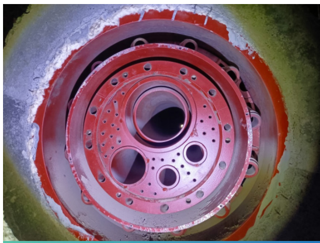
窑头多组分高效混合燃烧器
