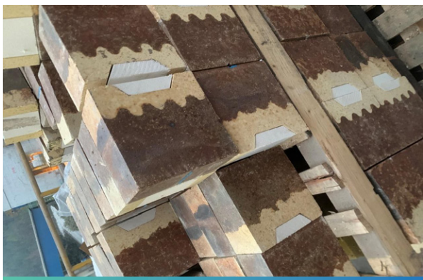
低导热耐磨耐火砖
