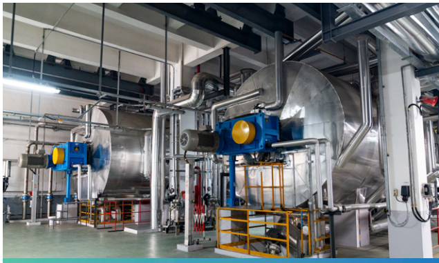
聚酯生产线的终聚两尾工艺
