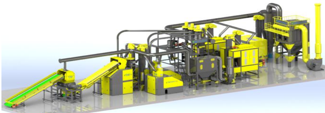
废线路板资源化利用系统
